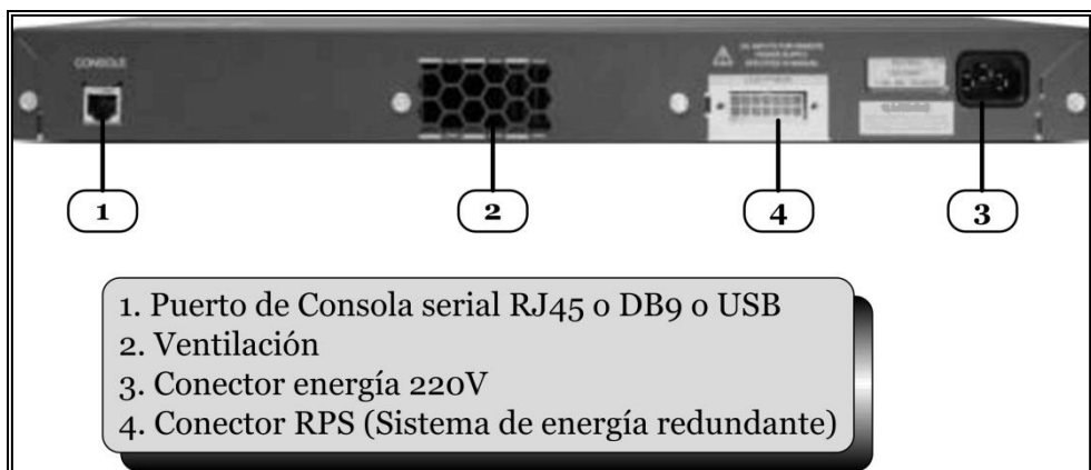
Fig. 3.8. Administración local del conmutador a través de un puerto de consola.
